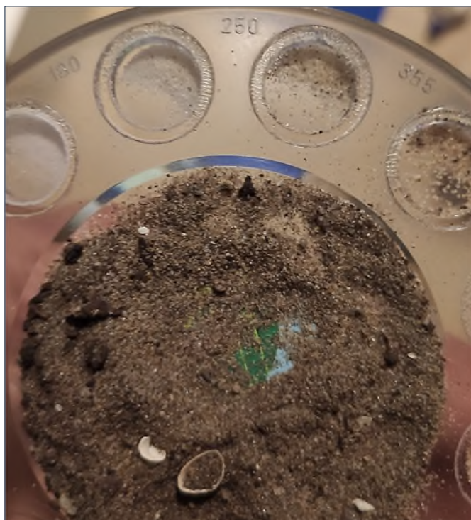
Afbeelding 4.7 zandfractie bij profielboring.
